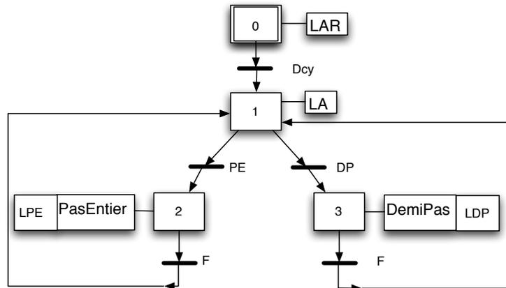
Ce grafcet comprend 4 entrées capteurs reliées aux bouton poussoirs (de type monostable) *Dcy*, *PE*, *DP* et *F*.
