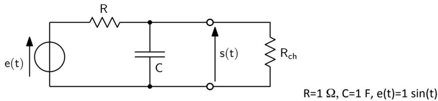
1. Calculer la source de Thevenin ( $\underline{e}_{th}$  et  $\underline{Z}_{th}$ ) équivalente vue par la charge (résistance  $R_{ch}$ ). Faire l'application numérique.
