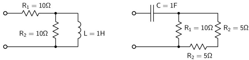
Calculer l'impédance équivalente complexe (module et argument) vue entre les deux bornes des deux circuits donnés ci-dessus, à une pulsation de 5 rad/s.
