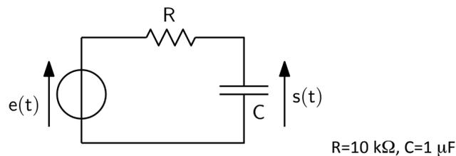
1. Soit  $e(t)$  une tension sinusoïdale d'amplitude 10 V et de pulsation 100 rad/s. Donner l'expression de la tension de sortie  $s(t)$ . Donner son amplitude (en volt), et son déphasage (en degrés).
