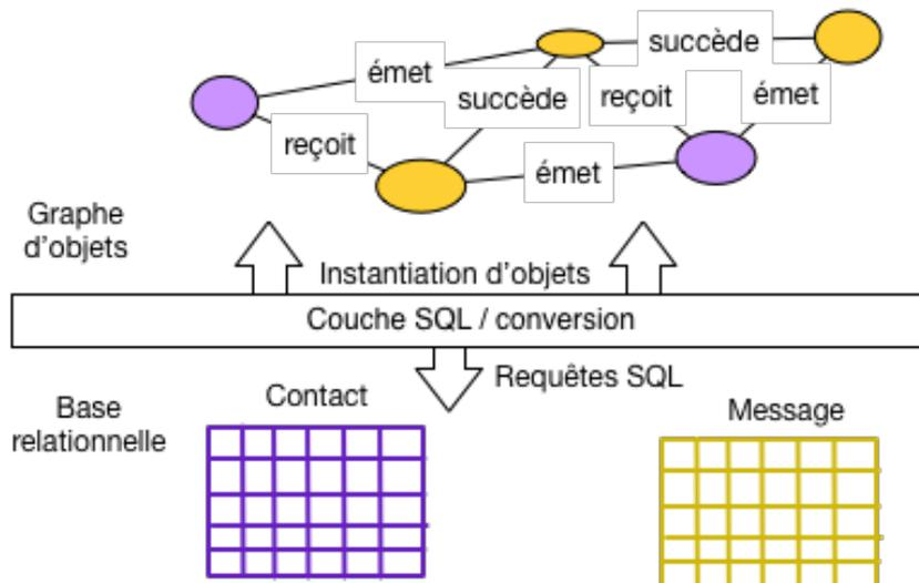
Fig. 9.10 : Architecture d'un système ORM
