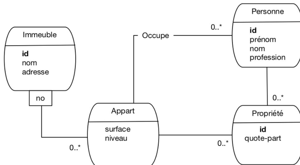
Fig. 6.17 : Le schéma E/A des immeubles avec réification
