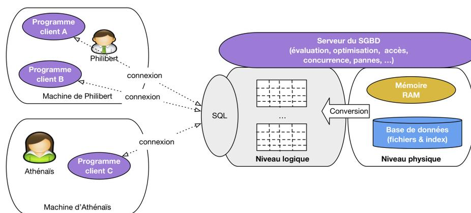
Fig. 1.4 : L'interface « modèle / langage » d'un système relationnel
