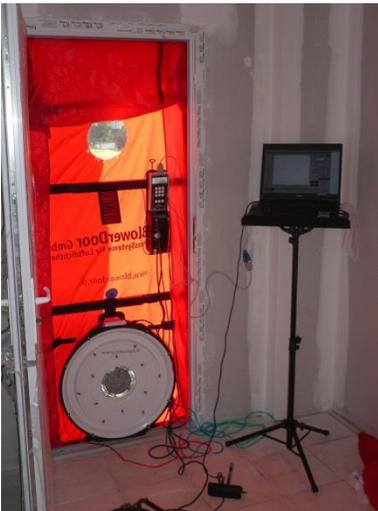
Il s'agit d'extraire des volumes d'air connus et de mesurer simultanément des différences de pression entre l'intérieur et l'extérieur afin d'obtenir une série de couple « débit/pression ».
