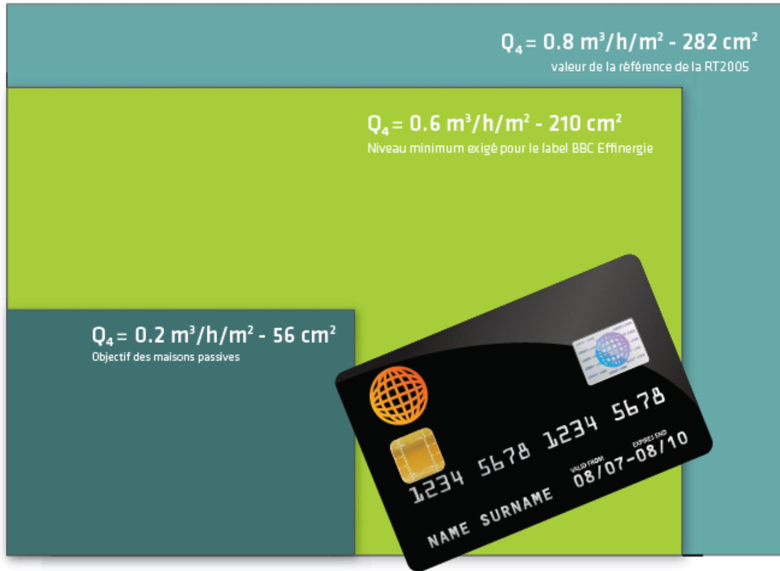
Cela correspond à la surface équivalente de fuite pour une maison individuelle de 110 m<sup>2</sup> de surface habitable, 2,5 m de hauteur sous plafond (soit un volume de 275 m<sup>3</sup>) et dont la surface de parois froides est de 196 m<sup>2</sup> (soit  $V / \text{APF-RT} = 1,4 \text{ m}$ ). *Source : CETE Lyon*
