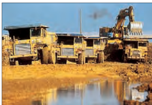
L'extraction frontale (ou en butte), avec un atelier pelle - tombereaux.
