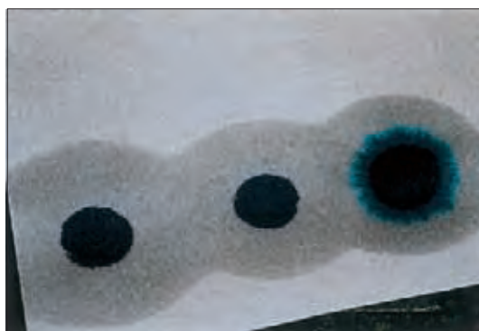
Auréole bleue apparaissant à la périphérie de la tache indiquant la fin de l'adsorption du bleu sur le sol.
