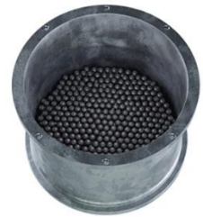
Détail d'un tambour avec 2,5 kg de billes d'acier
