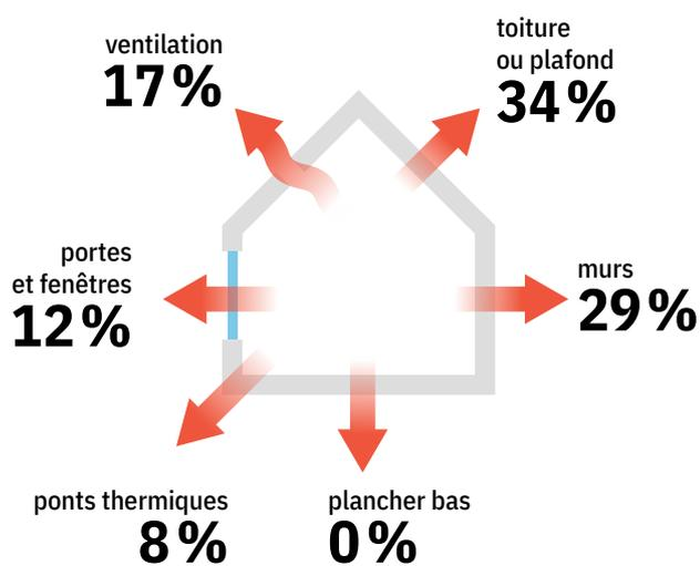
Coefficient de déperditions thermiques = 2 W/(m².K)
