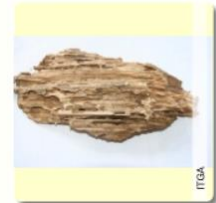
Aspect feuilleté et nourriture stockée. y a aussi de la vermorelure d'Oligomerus)
