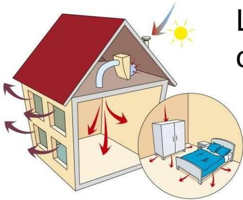
L'air puisé est filtré et **réchauffé** avant d'être introduit dans la maison.
