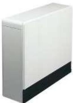
**Radiateur à accumulation** : Il s'agit d'un gros bloc conçu pour « stocker » de la chaleur la nuit (quand le tarif de l'électricité est moins élevé) afin de la restituer tout au long de la journée. Il est constitué d'un matériau à forte inertie thermique (brique réfractaire).
