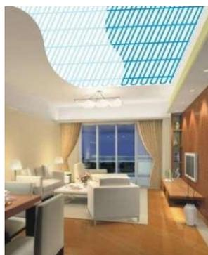
**Plafond chauffant électrique (plâtre : PRP)** : Utilise des panneaux autoporteurs, constitués d'une couche de laine minérale sous laquelle un film chauffant est collé en usine posés sous des plaques de plâtre.
