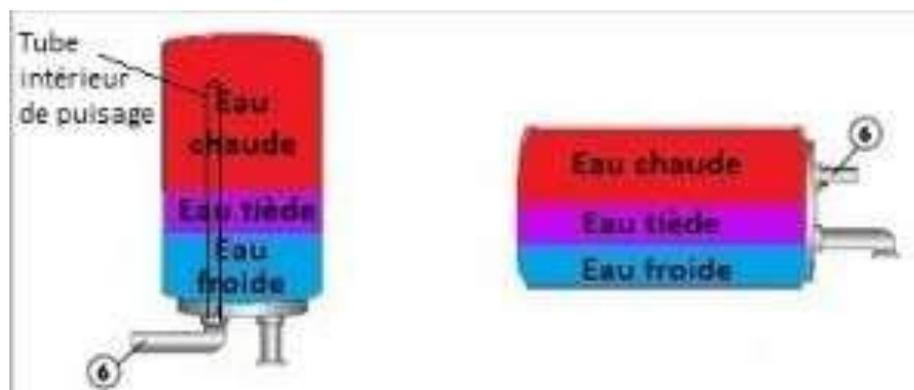
Dans le cas du ballon horizontal, augmentation de la zone de mélange et augmentation de la surface d'échange de l'eau la plus chaude.
