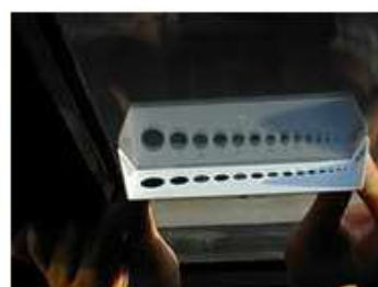
Lecture épaisseur lame d'air : 12 mm
