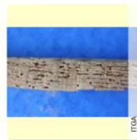
Galeries ouvertes vers l'extérieur
