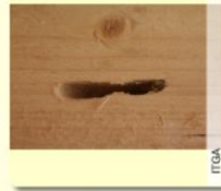
Trous de sortie de capricorne de bois frais
