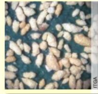
Vermoulure en forme de citron
