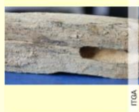
Trou d'entrée et de sortie
