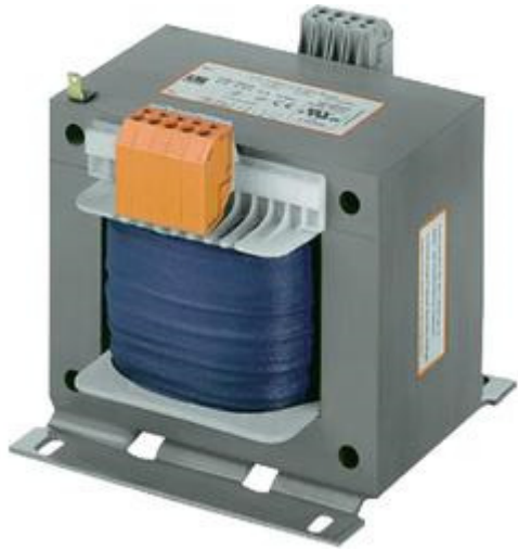
Transformateur monophasé : 50 Hz, 230V/24 V - 100VA
