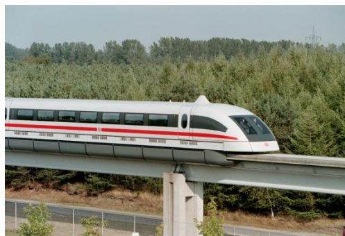
Train à sustentation magnétique (Transrapid allemand)
