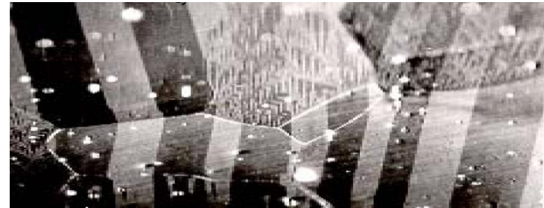
Fer au microscope : domaines de Weiss
