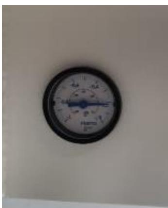
Le vide va commencer à se faire dans l'empreinte dans la table, vérifier ensuite la valeur de dépressions sur le manomètre qui doit être de -0,2 bar.
