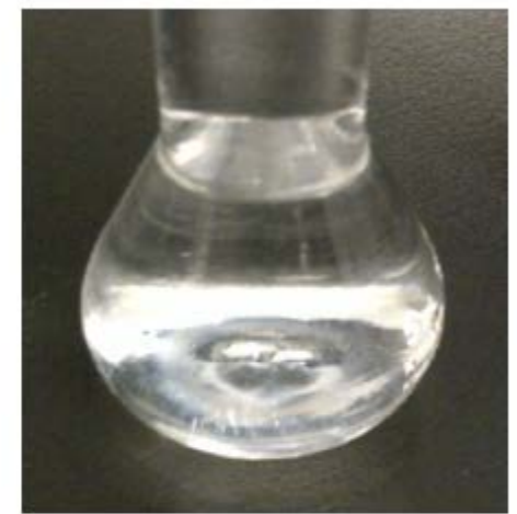
Echantillon après filtration et centrifugation à 12000RPM Solution limpide(OK)
