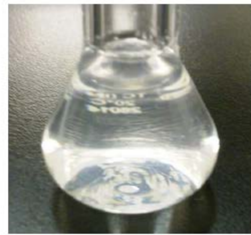
Echantillon après filtration sur 0.2µm Particules très fines: Solution trouble (toujours mauvaise )
