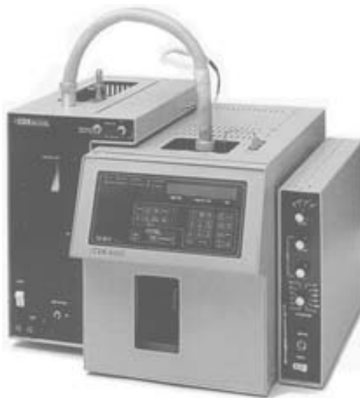
Figure 21.6 Espace de tête, modèle dynamique associé avec un chromatographe en phase gazeuse. Les flacons échantillons sont pressurisé avec le gaz vecteur du chromatographe. Le système « purge and trap » combine la préparation (simple) de l'échantillon, sa désorption et son introduction dans la colonne du chromatographe (modèle EA600 reproduit avec l'autorisation de la société CDS Analytical).
