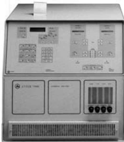
Figure 11.17 Analyseur de soufre et d'azote. Modèle 7 000 NS reproduit avec l'autorisation de la société Atek. Cet appareil réunit deux techniques de luminescence : l'azote est dosé par chimiluminescence (voir diagramme, figure. 11.13) et le soufre par fluorescence de \text{SO}_2 (excitation UV).
