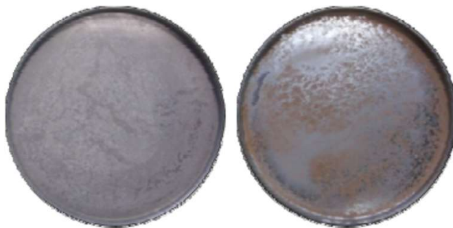
Coupelles avec résidu sec d'eau et matières en suspension
