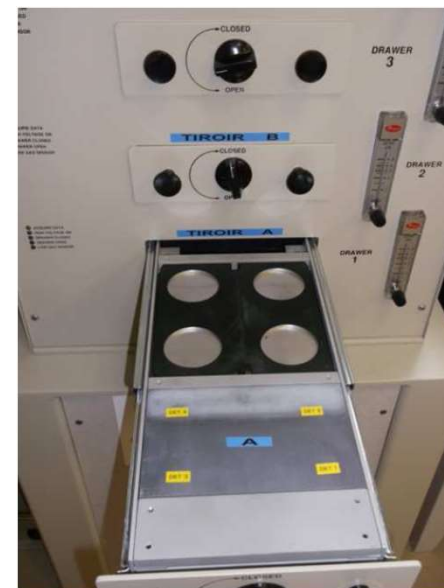
Tiroir d'un compteur proportionnel Itech G542 M - Quad
