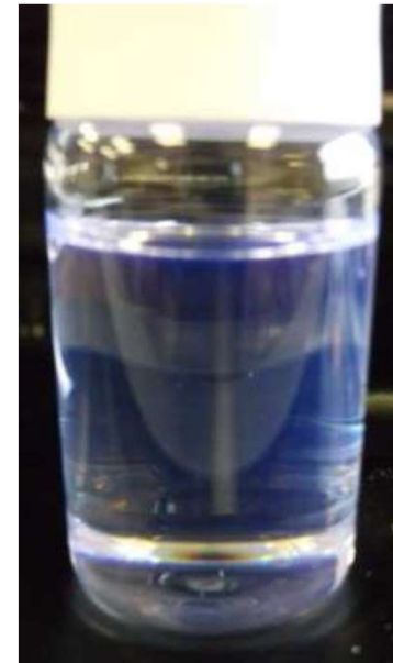
Mélange échantillon – liquide scintillant
