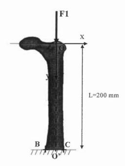
Si on considère que la surface de section de l'os est constante et égale à  $0.002 m^2$ . La contrainte maximale dans l'os induite par F1 est de
