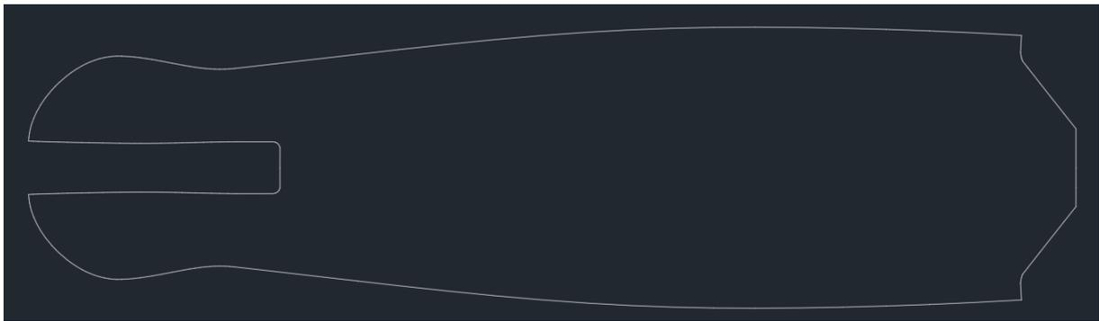
*Figure 4 : schéma du plateau de la trottinette*
