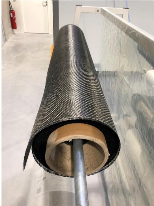
*Figure 3 : photo du rouleau de carbone 600gr/m<sup>2</sup> 0°/90°*
