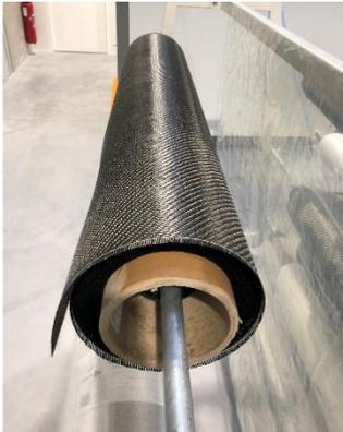
Les plis de carbone G0986 sont composés de fibres orientées à 0 et 90 degrés. Le but de ces plis est d'augmenter les caractéristiques mécaniques du deck en traction et en cisaillement. Une poudre est présente sur les deux surfaces du tissu. Celle-ci permet, lorsqu'elle est chauffée, de créer une cohésion entre les fibres afin que la préforme ne se défasse pas lors de sa manipulation.
