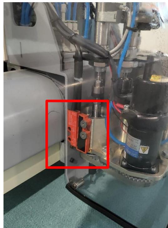
Avant tout mouvement de l'ensemble mobile, vérifiez que le capot est fermé et que le capteur de sécurité est bien en place.
