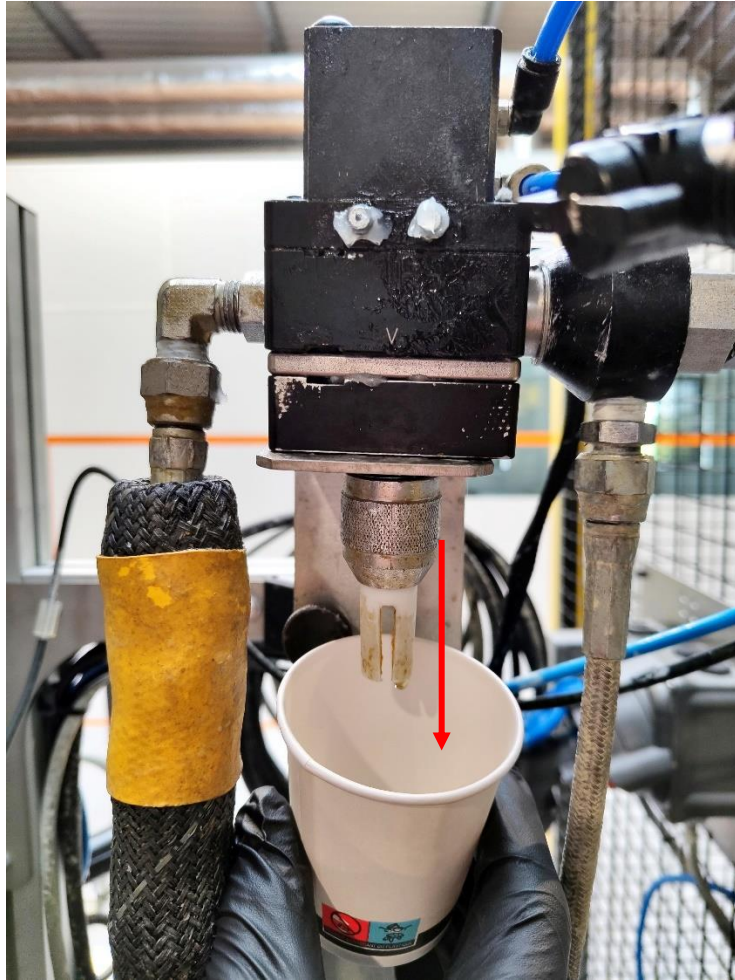
La coulée du durcisseur se fait en goutte à goutte
