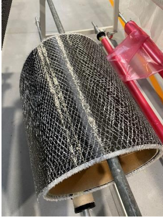
Figure 3 : Rouleau de carbone UD Saertex
