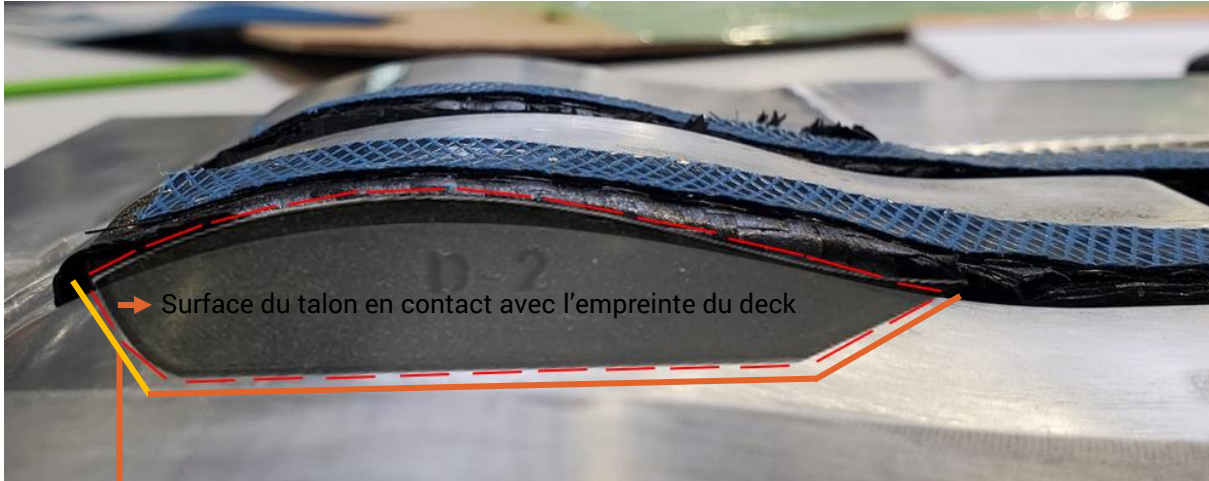
Figure 9 : Position des talons dans l'empreinte de la table de préformage
