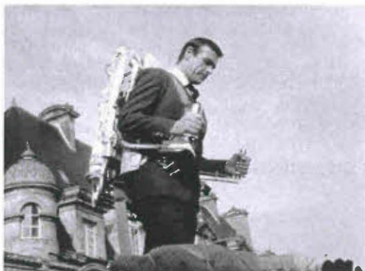
Le principe de la rocketbelt est le suivant : Du peroxyde d'hydrogène très concentré est envoyé sous pression dans une chambre de réaction contenant un catalyseur. La réaction est instantanée, provoquant un important dégagement de gaz chaud ( $700^{\circ}\text{C}$ ) composé de vapeur d'eau et d'oxygène. Le mélange s'évacue à grande vitesse dans les tuyères et fournit ainsi la poussée nécessaire pour faire voler « double-zéro sept »
