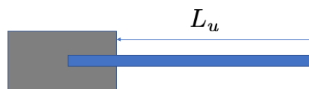
FIGURE 3 – Chauffage d’une éprouvette encastrée d’un côté.
