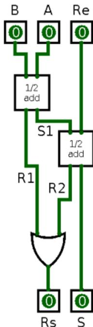
Chaînage des additionneurs 1 bit :
